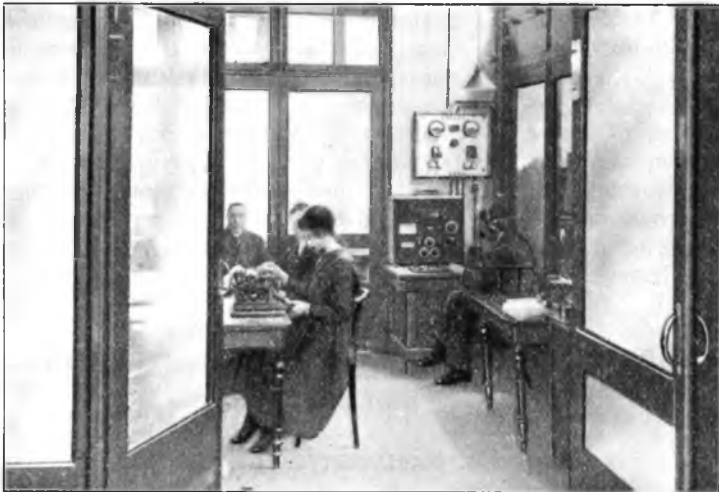
Fig. 1. De telefoniezender in het kantoor te Rotterdam.
